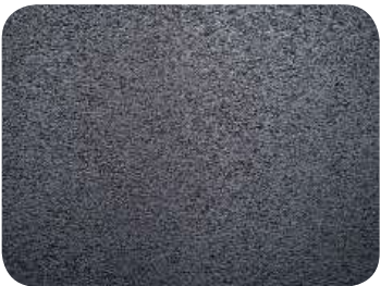
1 VOIE ET TROTTOIR EN ENROBÉ NOIR
