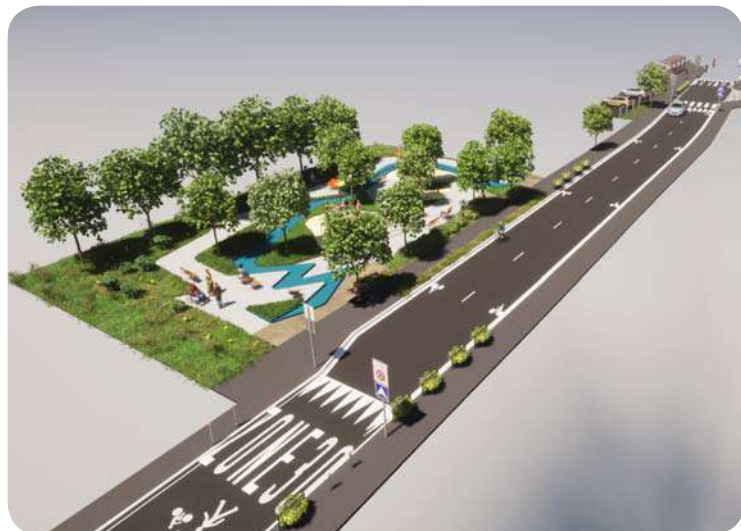
CHAUSSEE SURÉLEVÉE AU NIVEAU DU JARDIN DE LOISIRS AVEC UNE VOIE PARTAGÉE - ZONE 20
