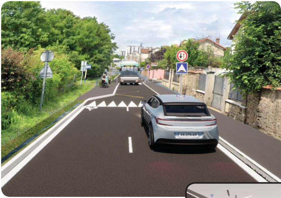
SÉCURISATION DE L'ARRET BUS CAR IMPOSSIBILITÉ POUR LES AUTRES VÉHICULE PRÉCÉDENT DE DOUBLER LE BUS À QUAI
